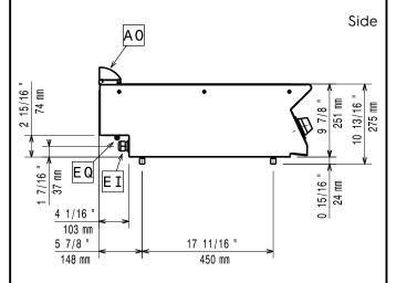
Electrical inlet (power) Equipotential screw EQ
