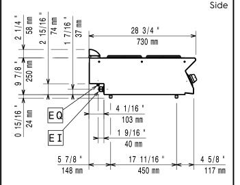
Electrical inlet (power) EQ Equipotential screw
